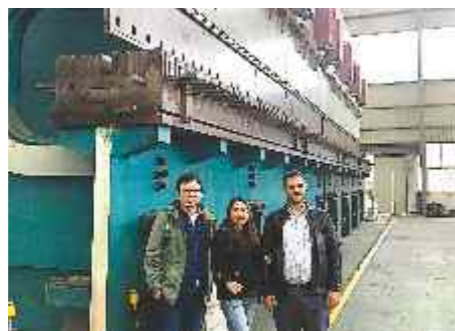
ماشین پرس برک ۲۰ متری ۶ هزار تن قدرت
