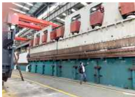
ماشین پرس برک ۲۰ متری ۶ هزار تن قدرت
